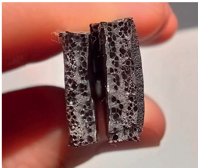
Obr. 5 – Porozita svarového spoje.
